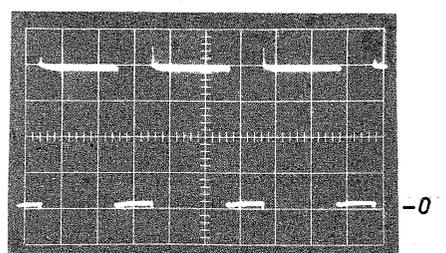
Bild 10. Spannung an der Anode des Thyristors GTO. Maßstab: vert. 100 V/T, horiz. 20  $\mu$ s/T
