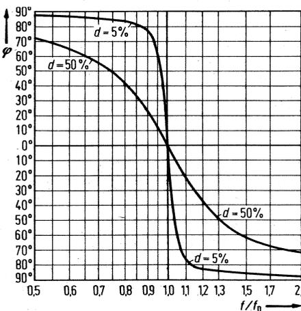
Bild 1. Normierter Phasenverlauf von Schwingkreisen mit Dämpfungswerten  $d = 5\%$  und  $d = 50\%$
