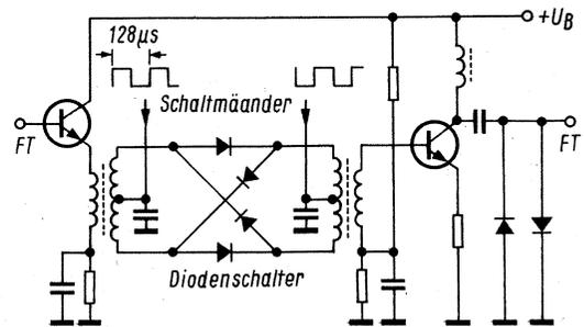
Einem elektronischen Umschalter, der mit halber Zeilenfrequenz gesteuert wird, werden zwei Träger zugeführt.
