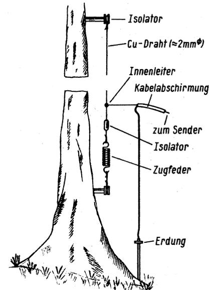
Bild 7. Vertikal-Langdrahtantenne, an einem Baum verspannt
