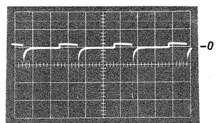
Bild 9. Gate-Strom des Thyristors GTO. Maßstab: vert. 1 A/T, horiz. 20  $\mu$ s/T (neg. Spitzenwert = 3 A)
