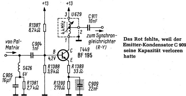
Das Rot fehlte, weil der Emitter-Kondensator C 909 seine Kapazität verloren hatte
