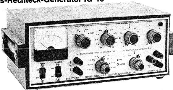
Volltransistorisiert • Liefert dekadisch einstellbare Sinus- und Rechteckfrequenzen von 1 Hz bis 100 kHz mit zusätzlichem Feinregler von 0,1 bis 1 Hz • Beide Signale an getrennten Ausgangsbuchsen gleichzeitig entnehmbar • Klirrfaktor unter 0,1% zwischen 10 Hz und 20 kHz • Zuschaltbarer 600- $\Omega$ -Abschlußwiderstand • 8stufiger Abschwächer im Sinus-, 3stufiger Abschwächer im Rechteckteil • Ausgangsspannung max. 10 Veff • Einbau-Drehspulinstrument mit zwei Spannungs- und einer dB-Skala
