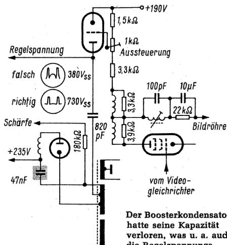
Der Boosterkondensator hatte seine Kapazität verloren, was u. a. auch die Regelspannungserzeugung beeinflusste
