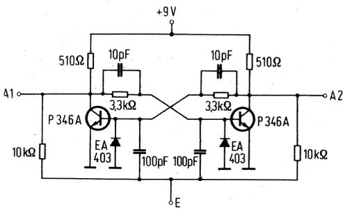
Bild 9. Schaltung einer Flipflop-Stufe
