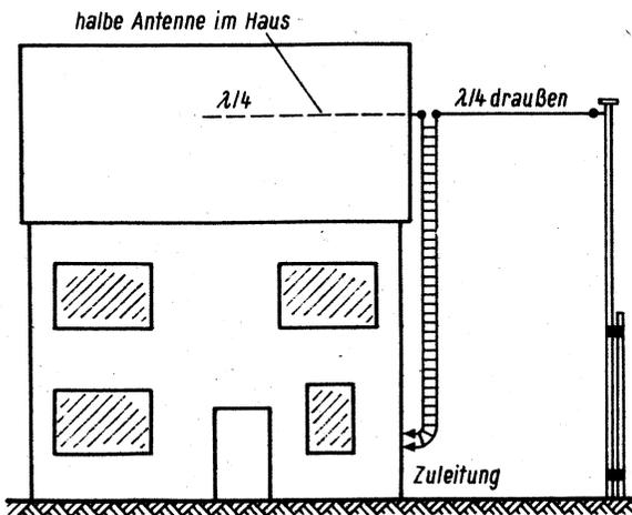
◀ Bild 8. Dipolantenne, teilweise im Dachboden verspannt
