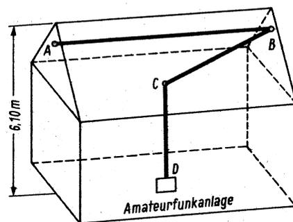
Schenkeln in zwei Ebenen, dessen Form an die Reinartz-Rahmenantenne erinnert (Bild 4). Wenn man sie für das 20-m-Band auslegt, läßt sie sich mit einer gewissen Fehlanpassung auch auf 15 m betreiben. Für 10-m-Betrieb wird empfohlen, zur korrekten Anpassung und richtigen Phasenspeisung den Isolator Is kurzzuschließen. Als Speiseleitung bewährt sich ein 50...80-Ω-Kabel.
