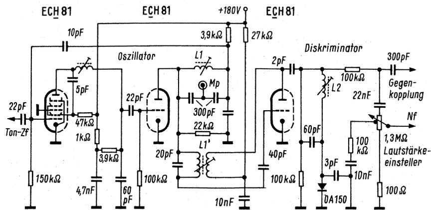
Durch einen Fehler im Syndro-Oszillator – der Kern der Oszillatorspeule L 1 bestand nur noch aus kleinen Bröckchen – fehlten Bild und Ton
