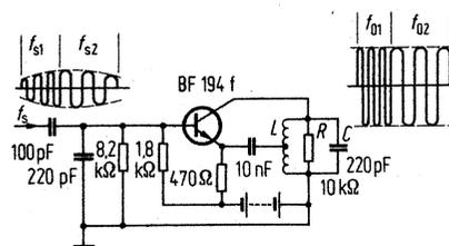
Bild 8. Prinzip eines mitgezogenen Oszillators. Die Oszillatorfrequenzen  $f_{o1}$  und  $f_{o2}$  werden durch die Steuerfrequenzen  $f_{s1}$  und  $f_{s2}$  synchronisiert
