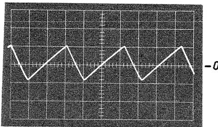
Bild 5. Spannung am Emitter des Transistors T 1. Maßstab: vertikal 1 V/T, horizontal 20  $\mu$ s/T
