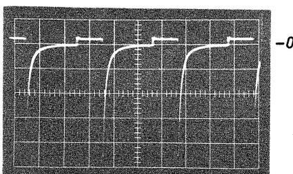
Bild 8. Spannung am Gate des Thyristors GTO. Maßstab: vertikal 5 V/T, horizontal 20  $\mu$ s/T
