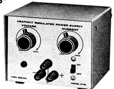
Liefert stufenlos regelbare Gleichspannungen zwischen 0 und 15 V bis max. 500 mA • Spannungskonstanz 0,05 % • Restwelligkeit unter 100  $\mu$ V • Strombegrenzung zwischen 10 mA und 500 mA stufenlos einstellbar • Ausregelzeit 25  $\mu$ Sek. • Ausgangsimpedanz 0,5  $\Omega$  • Externe Programmiermöglichkeit mit AC oder DC • Massefreier Ausgang mit zusätzlicher, geerdeter Massepolklemme
