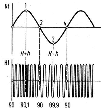
Bild 6. Umsetzen einer Tonfrequenzschwingung in Frequenzmodulation
