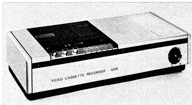
◀ Bild 1. Farbträchtiges Philips-VCR-Gerät, Typ 1205, mit eingebautem Empfangsteil
