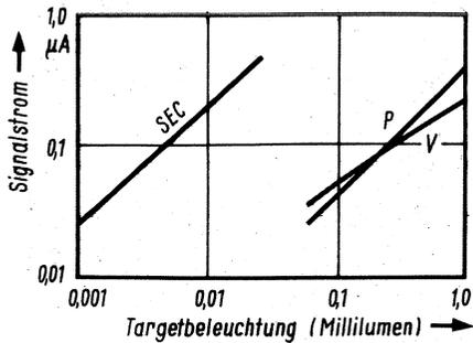
Bild 4. Empfindlichkeitsvergleich zwischen der SEC-Röhre und Röhren vom Typ Plumbicon (P) und Vidicon (V). Zum ersten Mal ist eine handelsübliche Farbkamera mit SEC-Röhren bestückt worden
