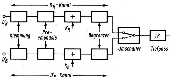
Bild 2. Blockschaltbild für die niederfrequente Aufbereitung der FD-Signale
