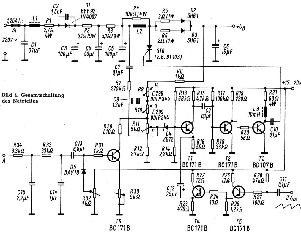
Bild 4. Gesamtschaltung des Netzteiles
