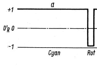
Bild 14a. Möglicher Verlauf der Farbsignalspannung bei richtiger Übertragung der zugehörigen Gleichspannungskomponente. Trennt man die Gleichspannung über einen Kondensator ab, so ergibt sich ein Signalverlauf nach Bild 14b. Man erkennt den wesentlich vergrößerten notwendigen Aussteuerbereich
