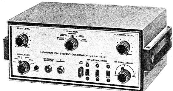
Liefert alle zum Abgleich von Stereo-Rundfunkgeräten erforderlichen Prüfungssignale • Mittelfrequenz 100 MHz  $\pm 2\%$  • Pilotfrequenz quarzstabil 19 kHz  $\pm 2$  Hz • Eingebauter Wobbelsender mit Markengeber • Wobbelhub bis 750 kHz einstellbar • Wobelfrequenz 50 Hz • Fünf quarzstabile Eichfrequenzen von 10,7 bis 107 MHz • Modulations-Mischregler • Vier feste NF-Ausgangsfrequenzen • Max. Verzerrungen 5% • Dreistufiger HF-Abschwächer
