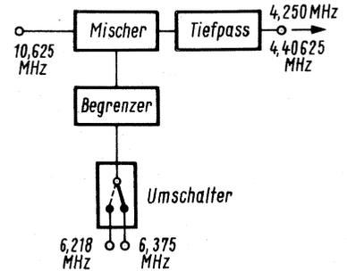
Bild 9. Blockschaltbild des Umsetzers
