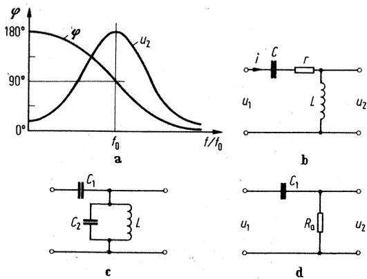
◀ Bild 3. a = Amplituden- und Phasenverlauf von Schwingkreisen in Vierpolschaltung. Bei der Resonanzfrequenz  $f_0$  beträgt der Phasenwinkel der Ausgangsspannung  $90^\circ$ ; b = Serienschwingkreis als Vierpol; c = Parallelschwingkreis mit kleinem Vorschaltkondensator  $C_1$  als Vierpol; d = Ersatzschaltung zu Bild 3c
