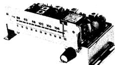
**UKW-Tuner-Einbauchassis FMT 41** für Empfangsanlagen, Koffergehäuse usw. Empfindliches Einbaugerät für UKW-Empfang, Frequ.-Ber. 86 bis 108 MHz, Empfindlichkeit besser als 10 µV (für 20 dB Rauschabstand), NF-Ausgang 500 mV an 25 kΩ, ZF 10,7 MHz, 6 Transistoren, 4 Dioden, Antenneneingang 75/240 Ω, Betriebsspannung 9 V, Maße 150 × 65 × 70 mm ..... **DM 59.-**
