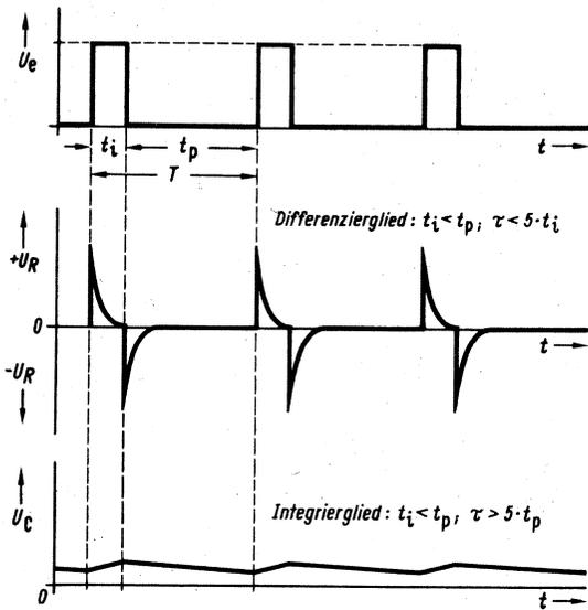
Bild 4.11. Rechteckimpulsfolge mit  $t_i \neq t_p$ ; Dimensionierung der Zeitkonstante beim Differenzierglied und beim Integrierglied
