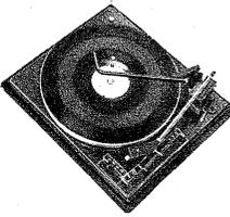
Spielt und wechselt bis zu 8 Platten, alle Geschwindigkeiten, leichter Rohrtonarm, mech. Aufsetzhilfe (Tonarmlift), Antiskating-Einrichtung, einstellbar 2/4/6 p, großer Plattenteller (28 cm), Stereo-Kristallsystem (internat. Systembefestigung), Gleichlauf: Wow unt. 0,2 %, Flutter unter 0,06 %, Netz 220-250 V, 50 Hz, Chassis seidenmatt schwarz, Bedienungsschalter u. Tonarm Metalleff. silber. Maße: 334 x 286 mm, unter Werkboden 49 mm - über Werkb. 98 mm ..... DM 79.-
