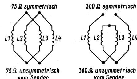
Bild 10. Schaltung eines Hf-Transformators (Balun) für 75-Ω-Eingang (unsymmetrisch) und 75-Ω-Ausgang (symmetrisch)
